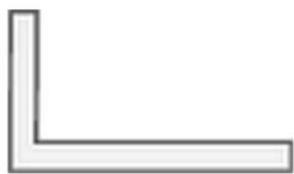
Rostbeständige Winkelprofile, W 1.4301 / 1.4307, AISI 304 / 304L, warmgewalzt, geeglüht, gebeizt oder laser-geschweisst, ungleichschenklig, in Herstellungslängen von ca. 5 - 7 m, Toleranzen nach EN 10056-2, DIN 1029, mechanische Eigenschaften nach EN 10088-3, mit APZ 3.1
