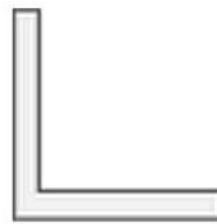
Profilé équerre en acier inox, W 1.4301 / 1.4307, AISI 304 / 304L, laminé à chaud, recuit, décapé ou soudé au laser, à ailes égales, en longueurs d'environ 5 - 7 m tolérances selon EN 10056-2, DIN 1029, caractéristiques mécaniques selon EN 10088-3 avec certificat de réception selon 3.1
